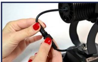
Conecte de nuevo el conector que une el cuerpo de proyector con la base.
