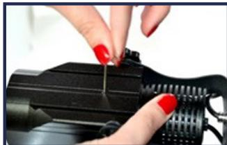
**2.** En el cuerpo del proyector encontrará un tornillo de cabeza allen, desenrosque para liberar el soporte interno del gobo.
