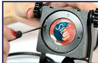
**4.** Coloque el porta gobos en la rosca del cuerpo de proyector y mediante el destornillador girelo hasta colocarlo en la posición inicial.
