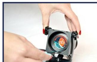
À l'aide du tournevis à tête fine fourni, faites tourner le support du gobo jusqu'à ce qu'il se détache du corps du projecteur.
