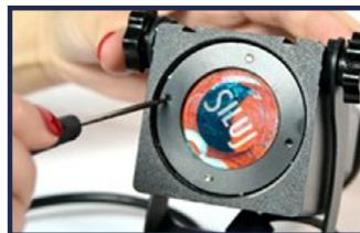
**4.** Placez le porte-gobo dans le filetage du corps du projecteur et, à l'aide du tournevis, tournez-le jusqu'à ce qu'il soit dans sa position initiale.
