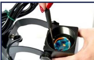
Cuando el porta gobos llegue a su posición inicial asegúrelo mediante el tornillo allen situado en el cuerpo del proyector, para eso utilice la llave allen suministrada.
