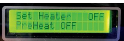
Seleccione esta función para inicializar el calentador. Cuando la temperatura alcanza el valor correcto, el dispositivo está preparado para funcionar.
