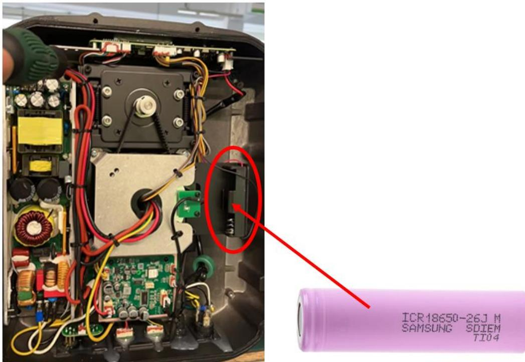
3. Inserte la batería (**modelo: 18650 \* 3,7V Li-ion**) en la ranura de la batería. Preste atención a la dirección correcta y la polaridad.
