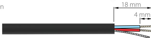
**C.-** Inserte los cables en los terminales y suéldelos
