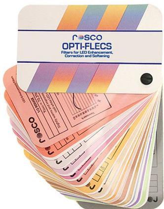
OPTI-FLECS está disponible en 21 colores y difusores estándar. El material tiene un grosor de 13 mil (0,33 mm, 0,013 pulgadas). La naturaleza semi-rígida del producto ofrece una solución de filtro protegida y reutilizable que puede insertarse en una multitud de proyectores LED utilizados en el escenario, en estudios de TV o en instalaciones arquitectónicas.
