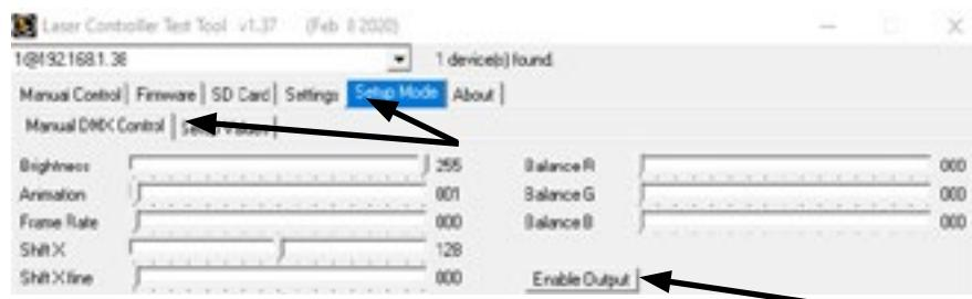
Sélectionnez l'onglet «Setup Mode» -> «Setup Values», comme illustré dans l'image ci-dessous:
