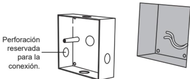
2 - Asegure la caja de montaje con los tacos adecuados para el soporte.
