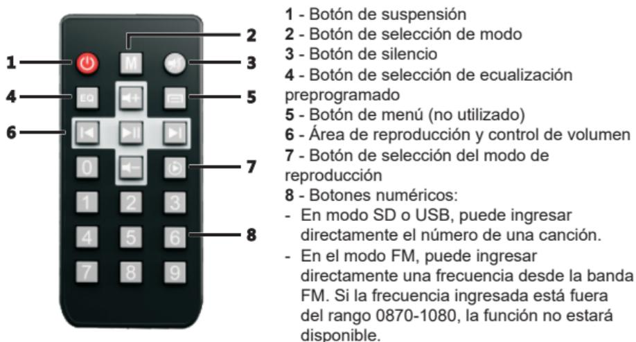
Por ejemplo, para obtener la frecuencia de 87.5 MHz, debe ingresar 0875.
