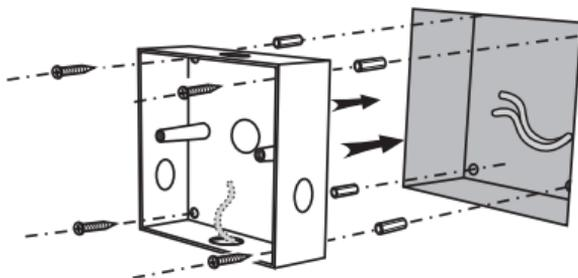
3 - Como se muestra en la figura siguiente, suelte el panel frontal y retire con cuidado la parte posterior del controlador.
