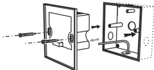
5 - Coloque el panel frontal teniendo cuidado de no dañar el conector de múltiples clavijas.
