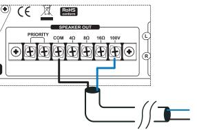
Brancher les deux fils à la sortie de votre amplificateur et selectionner la puissance désirée.
