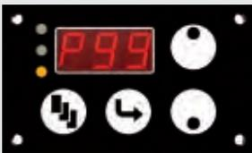
Abb. 3: Display-Anzeige bei Einstellen des Pumpenwertes
