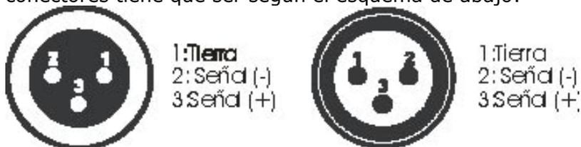
Conecte el conector XLR hembra a la salida del controlador, y la otra punta a la entrada en el aparato. Para enlazar dos aparatos, conecte el terminal hembra del cable al conector de salida en el aparato y el conector macho al conector de entrada en el otro aparato.
